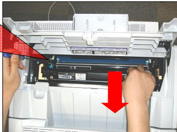
左手でロックを外して右手で筒状部を回転させます。
