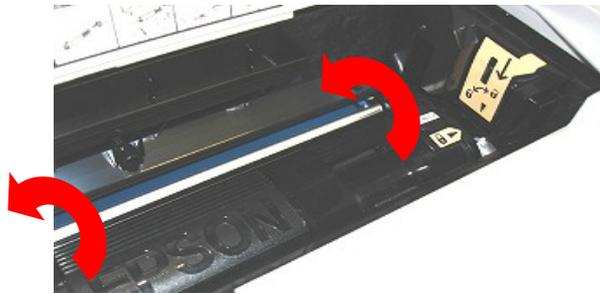
トナー装着をしてロックする部分が少し硬いですが上から両端を押さえて最後まで装着します。
